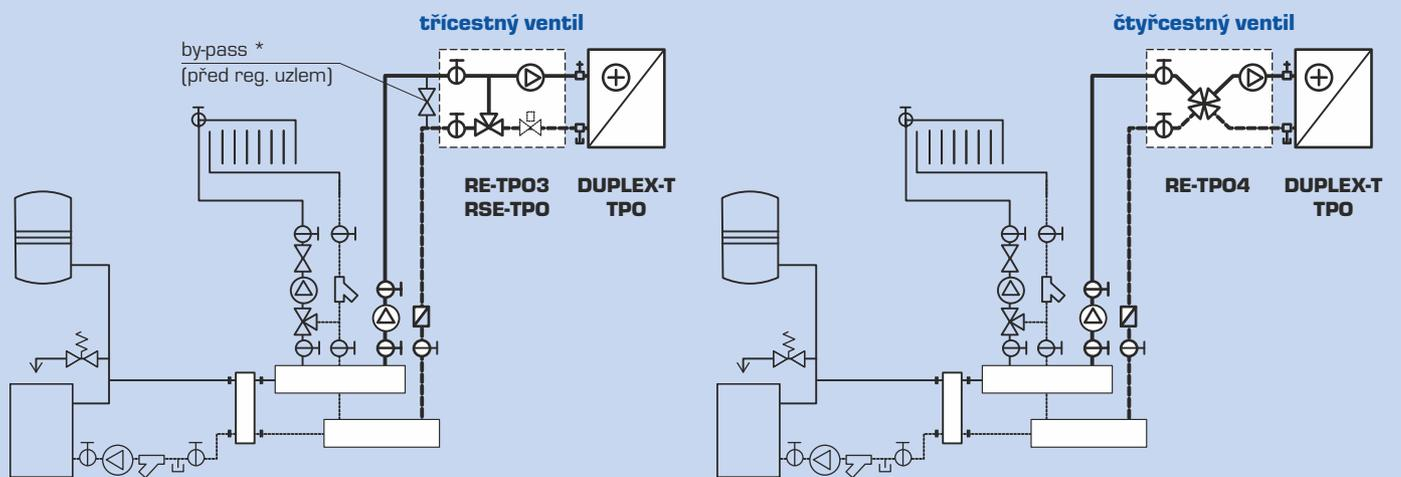
Instalace teplovodního ohříváče pro vzduchotechniku v systému vytápění budovy s oběhovými čerpadly v každé topné větvi.
