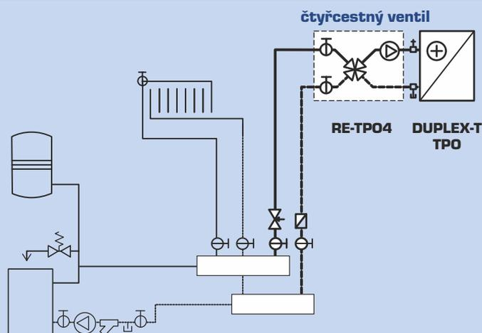
Instalace teplovodního ohříváče pro vzduchotechniku v systému vytápění budovy s centrálním oběhovým čerpadlem. Do topné větve vzduchotechniky je nutno osadit regulátor diferenčního tlaku (alt. ruční regulační ventil).
