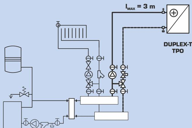
Instalace teplovodního ohříváče pro vzduchotechniku v systému vytápění budovy s čerpadly v každé topné větvi. Teplovodní ohříváč je v bezprostřední blízkosti rozdělovače (ve strojovně ÚT).
